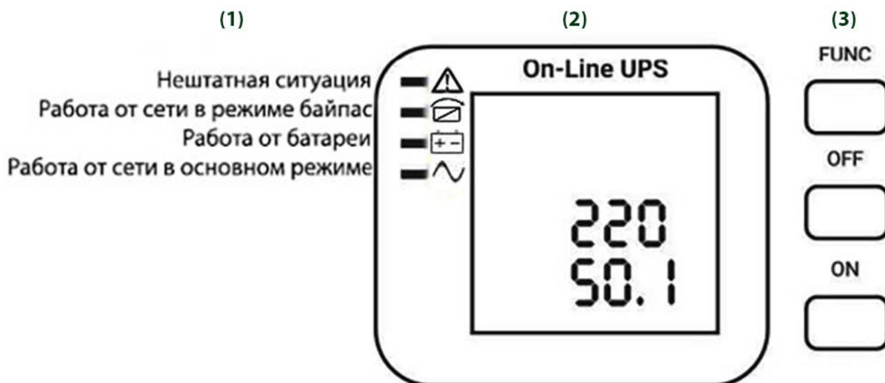
Рис.3. Панель управления ИБП
